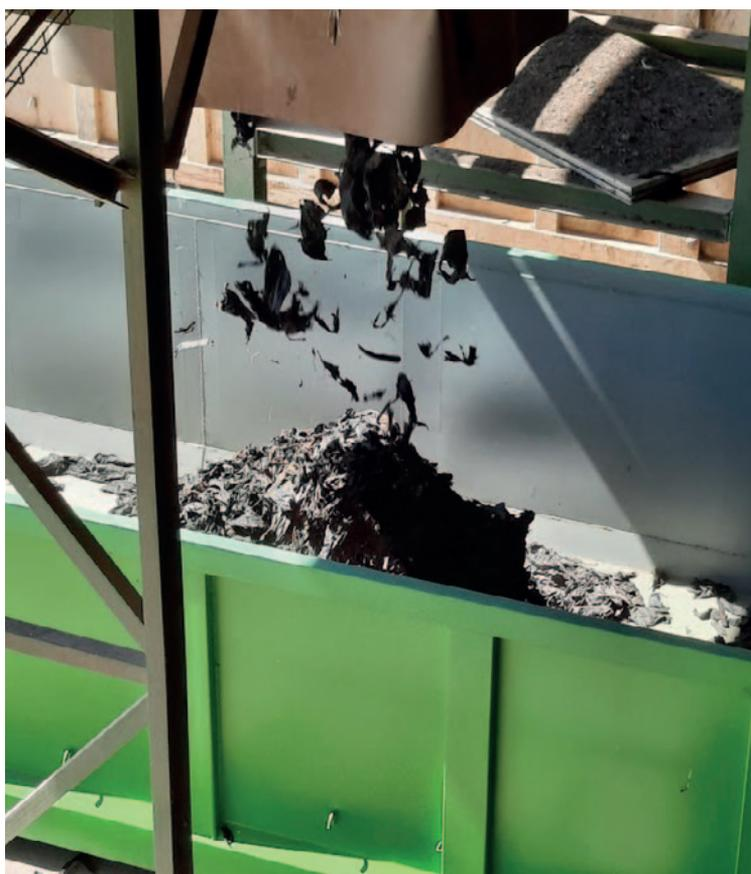
**El residuo plástico recogido en campo pasa por tres trómeles como este con filtros de 150 mm, 80 mm y 14 mm, en este proceso se calcula cuánto plástico se puede disgregar en cada trómel, del total de residuo trasladado al Centro de Tratamiento.**
