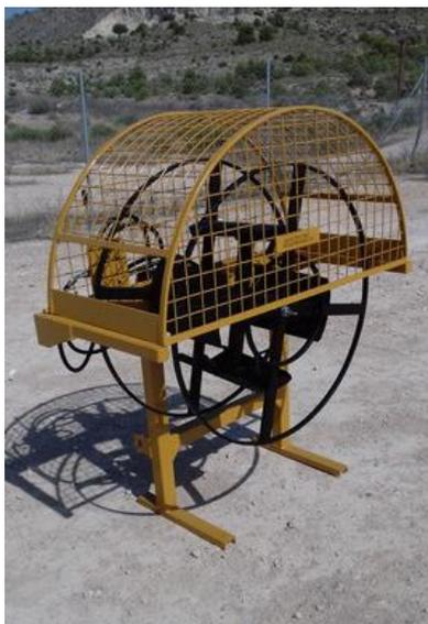
Figura 13. Máquina recogedora de cintas de riego.
