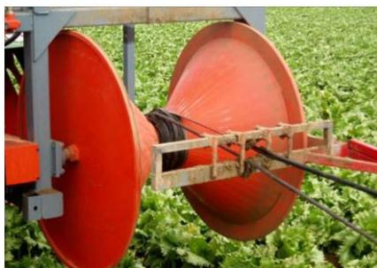
Figura 11. Momento de la retirada de las cintas de riego.
