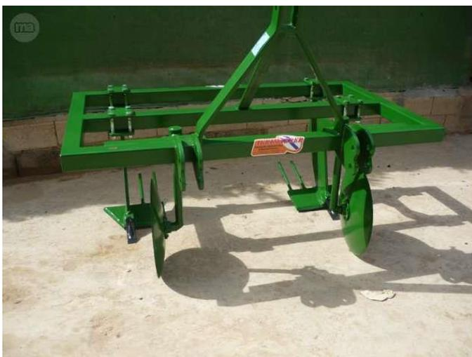
Figura 12. Máquina levantadora de plásticos de acolchado.
