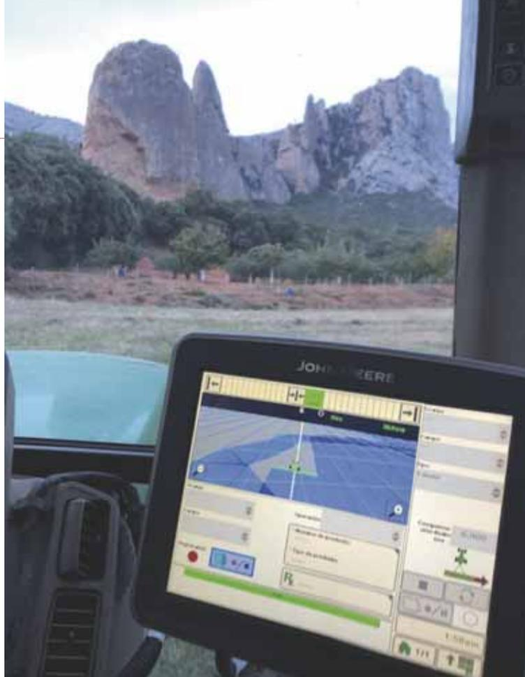
Sistema de autoguiado de gps a través del cual el agricultor puede realizar una siembra precisa.
